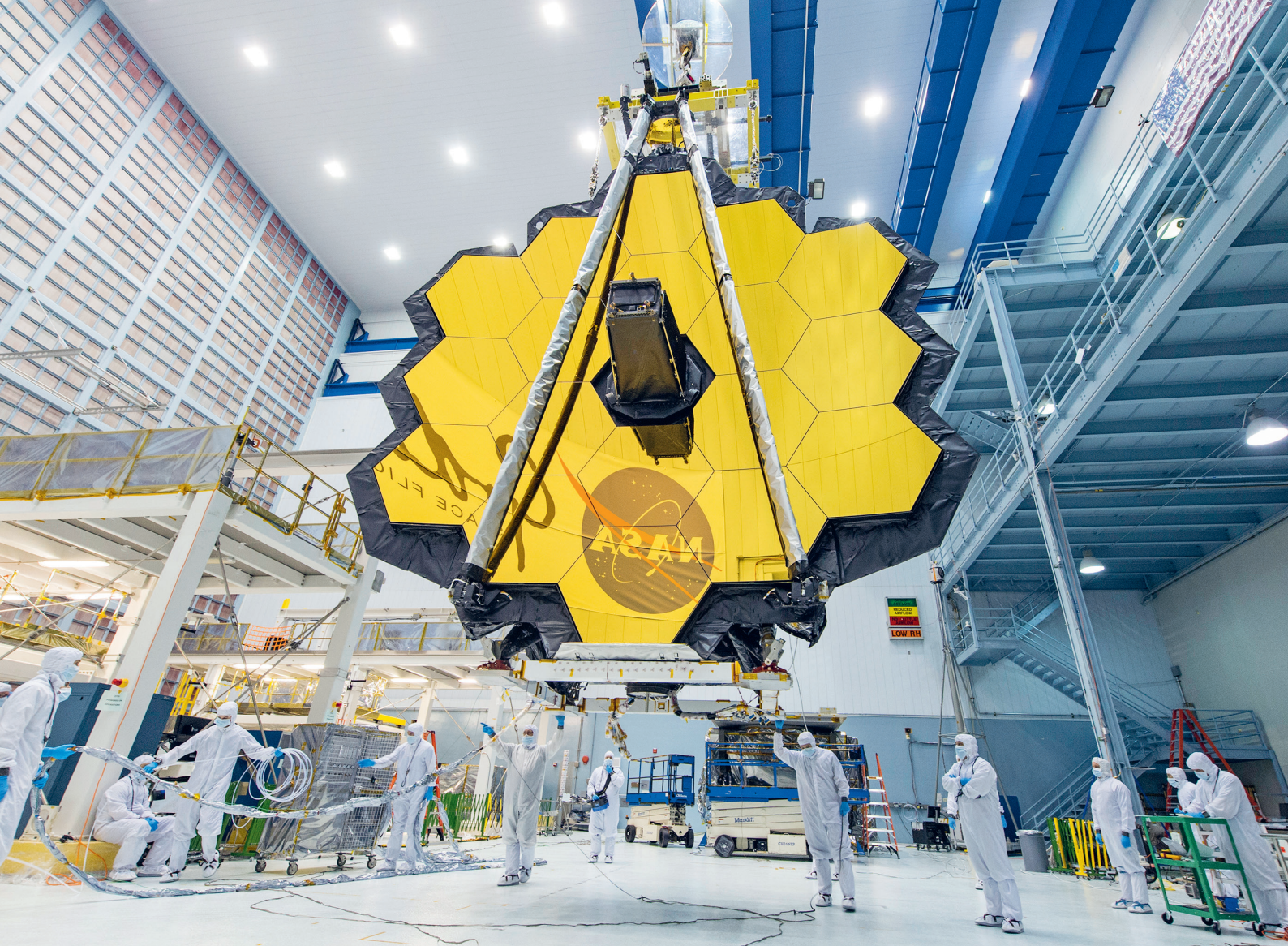
Techniker heben das Webb-Teleskop mit einem Kran an und bringen es in einen Reinraum im Goddard Space Flight Center der NASA in Greenbelt, Maryland. Der 18-teilige Goldspiegel ermöglicht es, das Infrarotlicht der ersten Galaxien einzufangen, die sich im frühen Universum gebildet haben.
